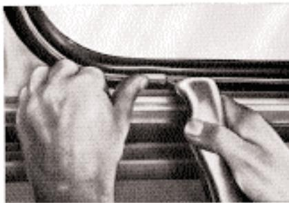
Dann ist die Fensterscheibe in das Klemmprofil mit Hilfe unseres Werkzeuges 365 0002 so einzusetzen, wie in den Absätzen 2 und 3 der „Arbeitsweise bei der Montage“ beschrieben.
